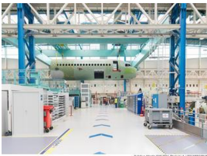
Transbordement d'un poste de travail à un autre après assemblage des fuselages et des pointes avant pour montage des portes et des hublots.
